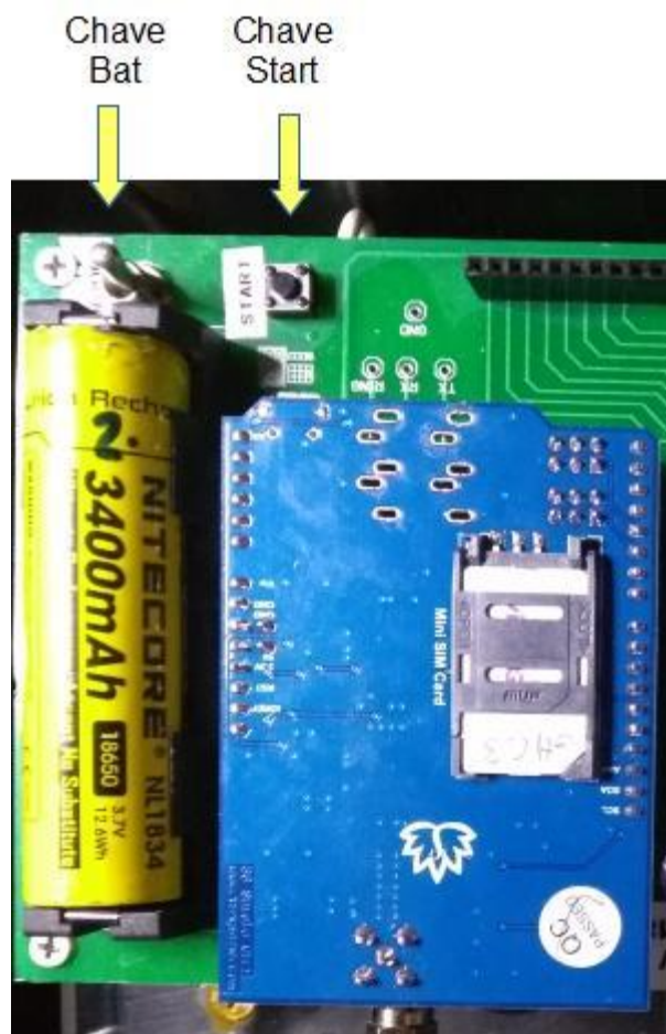
Fig 2 – Posição das chaves BAT e START e posição do chip da operadora
